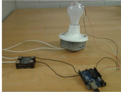
Figura 4. Esquema de conexión foco, Relay y Arduino.
